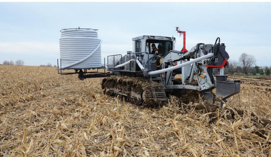
L'équipement de drainage agricole spécialisé utilise la technologie GPS pour assurer une installation précise
