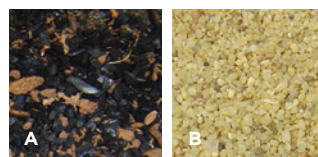
FIG.8 Mélanges des médias filtrants : A) CPZTM Mélange pour le retrait des matières en suspension, des nutriments, des métaux et des matières organiques ou B) Hydro Filter Sand pour le retrait des matières en suspension ainsi que des métaux et des nutriments fixés à des particules
